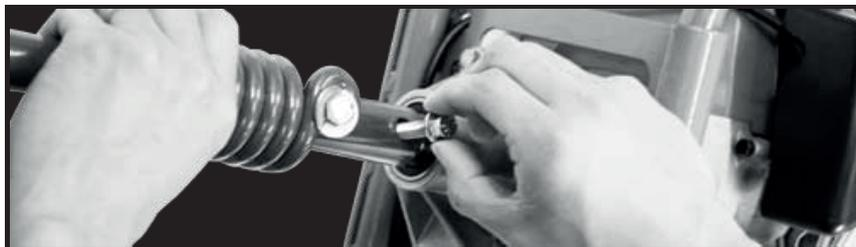
1. Inserte el mango de la llave de la bujía en el agujero transversal en el adaptador.
